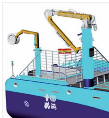
> Espacio optimizado a popa para facilitar la automatización en la estiba de redes, despejada al prescindirse de la panga.
