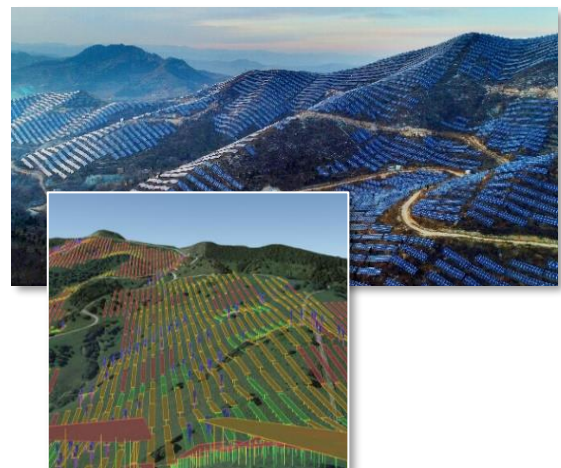
Fig. 14: Optimización 3D del Diseño de planta para minimizar el LCOE en terrenos de orografía complicada
