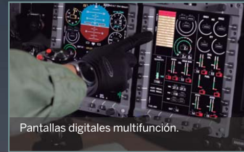
Sistema de navegación GTN 750. Sistema de aviso de proximidad al terreno HTAWS.
